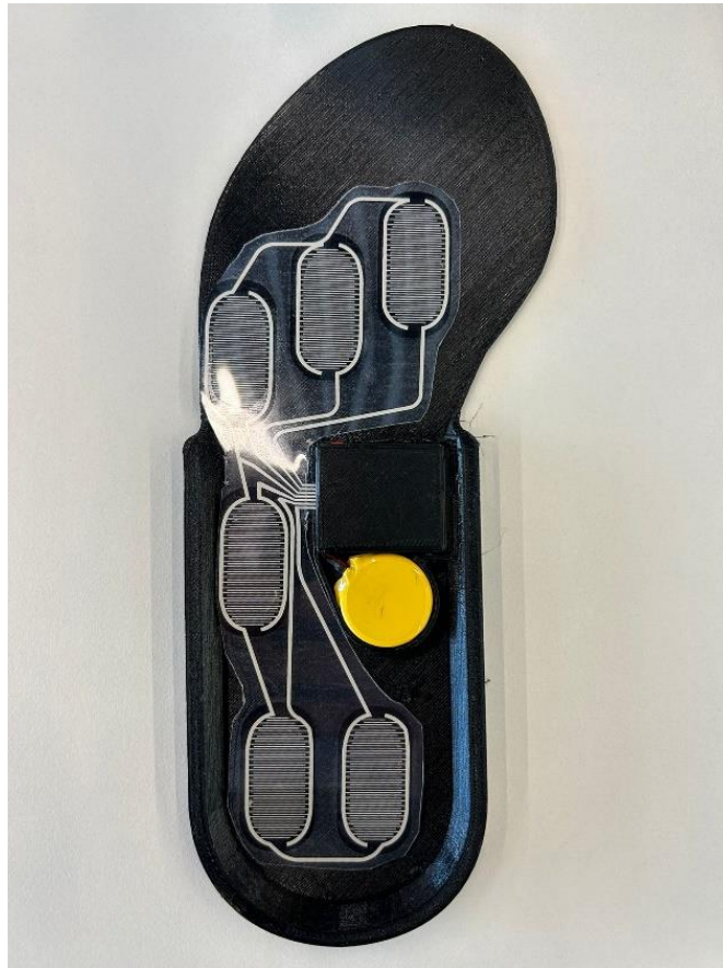
Figura 11. Estructura final de la electrònica encapsulada, la bateria (amarillo) y la plantilla de presiòn sobre material de plantilla de calzado final.
