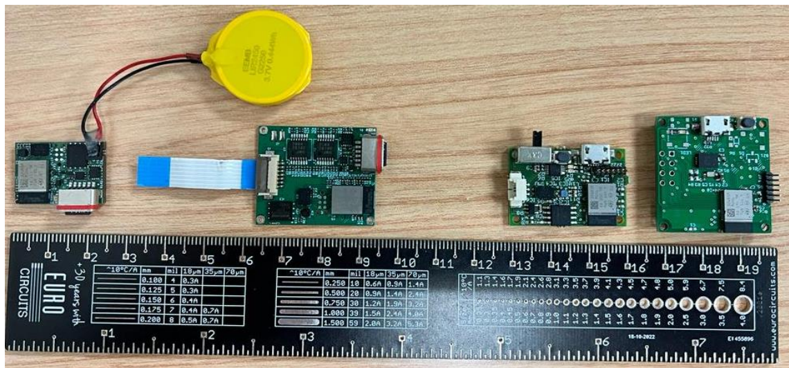
Figura 10. Cuatro modelos de electrónica desarrollados. De izquierda a derecha (Serie 2-Lite, Serie 2-Pro, Serie1-Lite, Serie 1-Pro)
