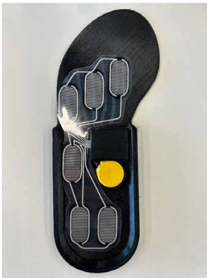
Figura 11. Estructura final de la electrónica encapsulada, la batería (amarillo) y la plantilla de presión sobre material de plantilla de calzado final.
